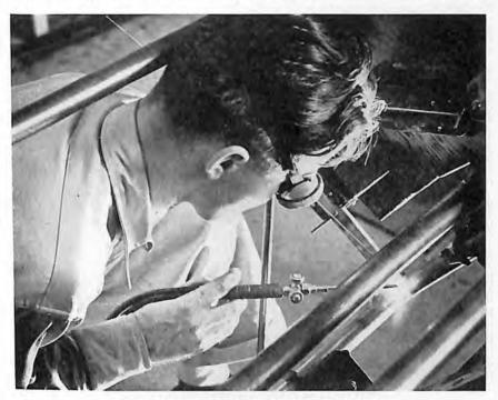
"DOWN-WELD" FOR EASE OF OPERATION
