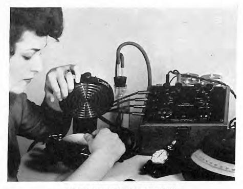
FABRIC TEST FOR GAS LEAKAGE
